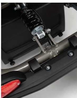
Die Pendelachse sichert die Fahrstabilität
