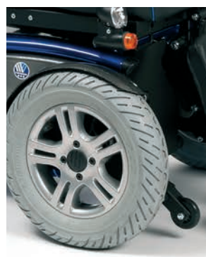
Bessere Manövrierbarkeit durch einen Vorderradantrieb
