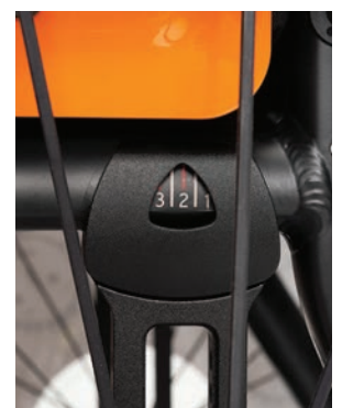
Die Hinterräder können in 8 verschiedenen Positionen vorwärts oder rückwärts verstellt werden.
