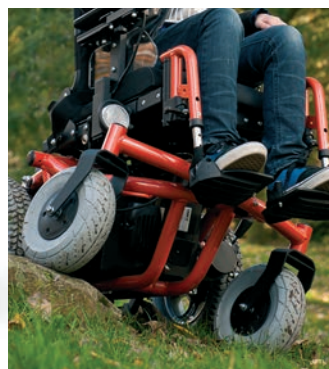
Die Pendelachse sichert einen permanenten Bodenkontakt auch im unwegsamem Gelände.
