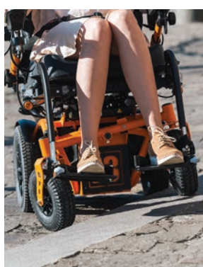
Dank der Pendelachse hat der Forest 3 immer Bodenkontakt, auch wenn es sich um unebenes Gelände handelt
